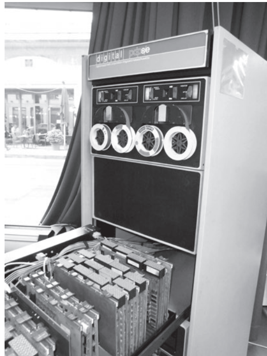
Figura 6 – PDP-8 aberto, exibindo seus módulos de memória.
